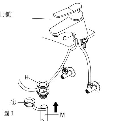
依序將V套入W與X內孔中，裝進壁上排水孔，固定方向(如圖 I )。
